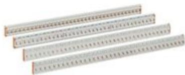
Pettine di cablaggio 3P+N per Btdin 2P - 36 moduli DIN - In 80A (alimentazione laterale) o 100A (alimentazione centrale) con neutro equilibrato
