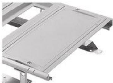
Pannello cieco altezza 150 mm per telai modulari larghezza 400 mm, per quadri Atlantic-E, Atlantic inox e Marina. Pannelli in ABS e fibra di vetro - RAL 7035. Tenuta al calore anomalo: T = 750°C. Fissaggio su supporti con viti ad 1/4 di giro
